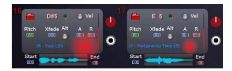
Chacun d'eux est déclenché par la réception d'une Note MIDI unique, qui peut être émise par un contrôleur externe (clavier, surface de contrôle...), le VeloPad ou le SpatialTrigger.
